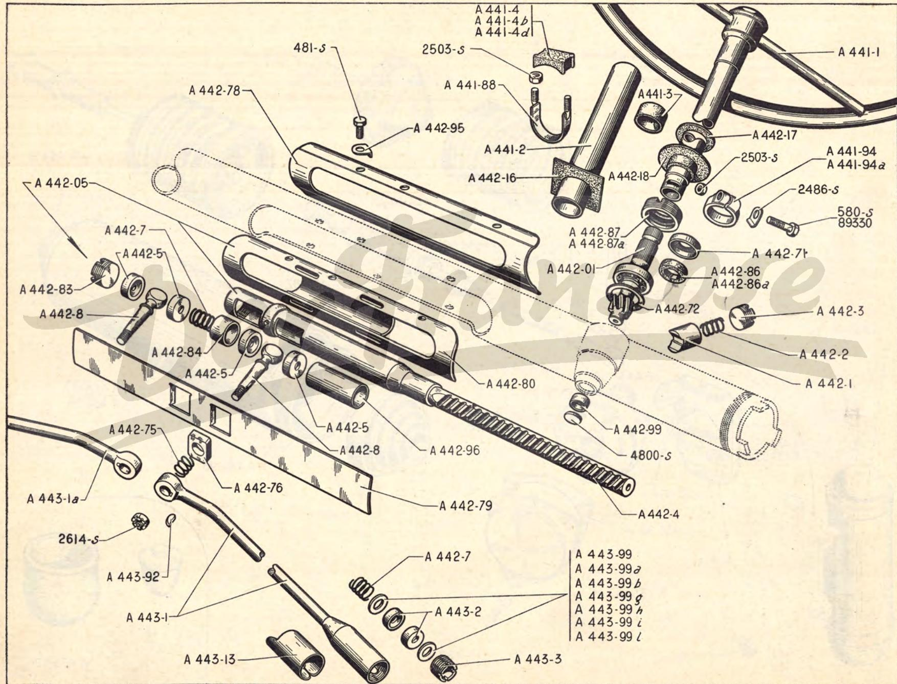
**DIRECTION - VOLANT - BARRES DE DIRECTION — 47**
